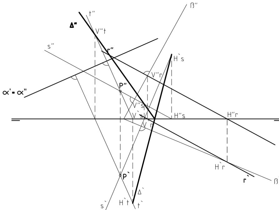
CONOCEMOS LA TRAZA HORIZONTAL Y LA TRAZA VERTICAL ABATIDA DE UN PLANO ALFA. HALLA SU TRAZA VERTICAL ASI COMO LAS PROYECCIONES DE UN CUADRILÁTERO ABCD CONTENIDO EN ALFA, SABIENDO QUE EL LADO BC ESTA EN EL PLANO VERTICAL Y MIDE 12 mm Y QUE EL LADO DA ESTA EN EL PLANO HORIZONTAL Y MIDE 24 mm.
