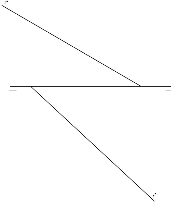
2.-SEÑALAR MEDIANTE UN CAMBIO DE PLANO VERTICAL DE PROYECCIÓN EL ANGULO QUE FORMA LA RECTA  $r(r'',r')$  CON EL PLANO HORIZONTAL.
