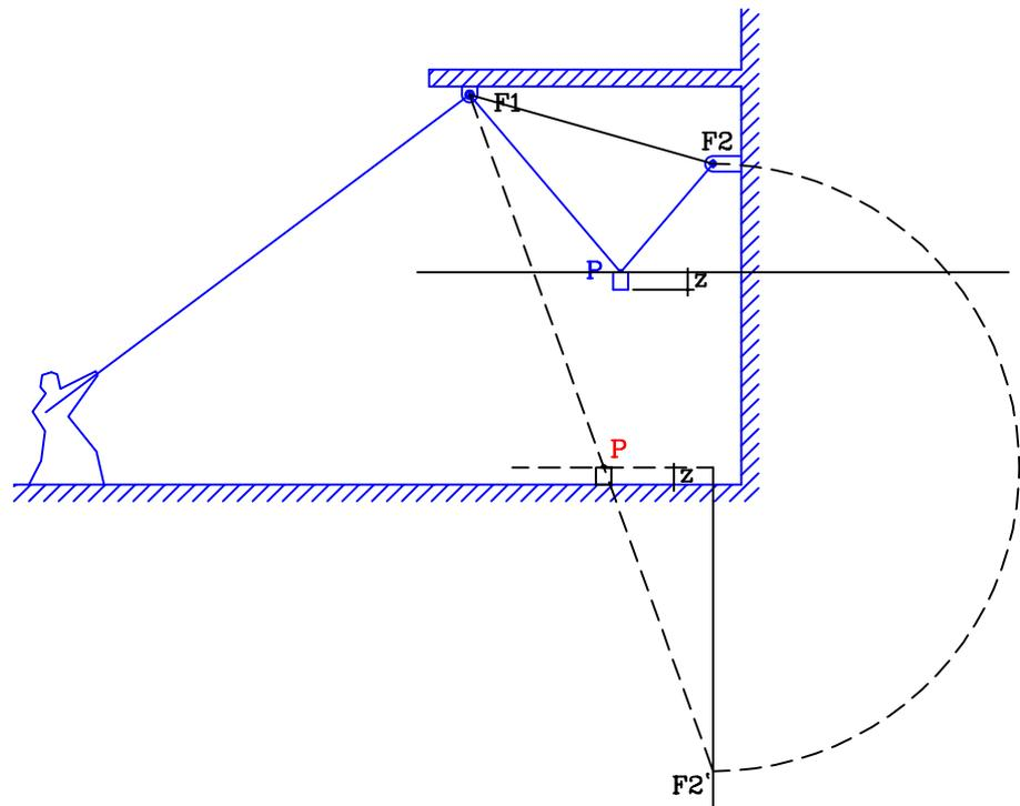
18.-HALLAR LAS POSICIONES EN LAS QUE SE DEBE SITUAR EL PUNTO A DE LA GRUA PARA QUE, AL GIRAR EN EL PUNTO C Y VARIANDO LA LONGITUD DE LA CUERDA, EL PESO P, QUE DESLIZA SOBRE LA CUERDA SE POSE SOBRE LA BARCA EN EL PUNTO SEÑALADO.
